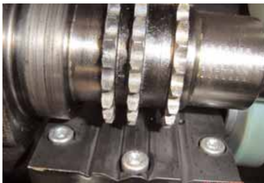
La dentatura e il piede degli ingranaggi sono obiettivi cruciali per i getti ad alta pressione nell'eliminazione delle scorie.
