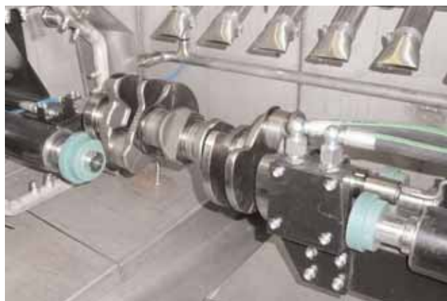
Getti ad alta pressione rimpiazzano spazzole convenzionali nella macchina di lavaggio per alberi motore, sviluppata da Hmm.
