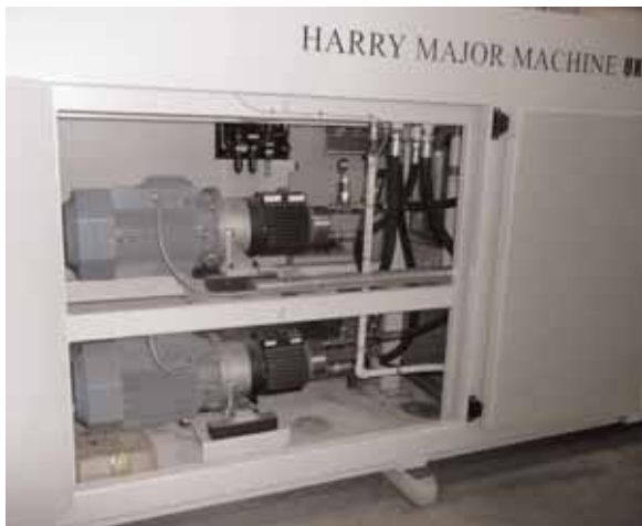
Il liquido chimico di pulizia, con pressioni fino a 170 bar, viene erogato dalle pompe Hydra Cell senza tenute meccaniche.
